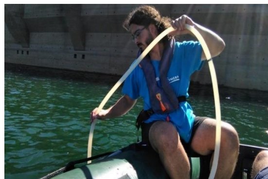
Figura 10. Toma de muestra integrada de agua mediante botella hidrográfica (izquierda) o tubo de silicona (derecha)
