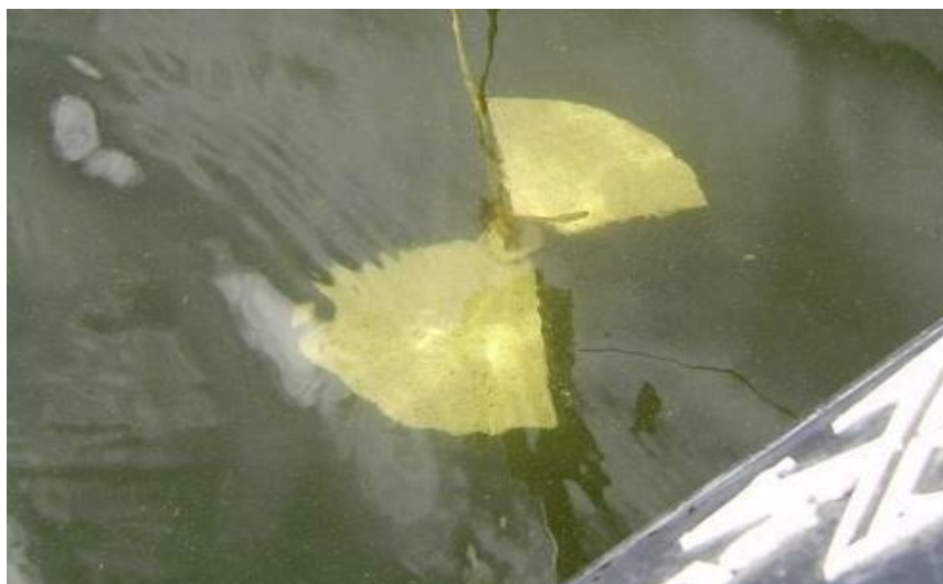
Figura 12. Uso del Disco de Secchi para medir la transparencia del agua y calcular la profundidad de la zona fótica
