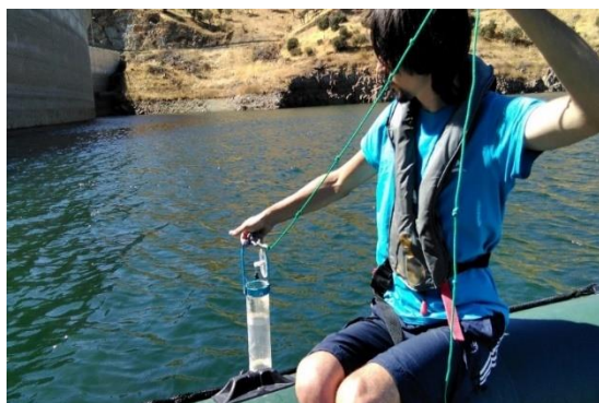
Figura 10. Toma de muestra integrada de agua mediante botella hidrográfica (izquierda) o tubo de silicona (derecha)
