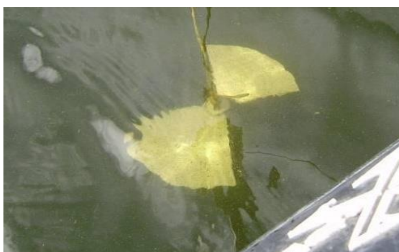
Figura 15. Uso de Disco Secchi para medir la transparencia del agua y calcular la profundidad de la zona fótica
