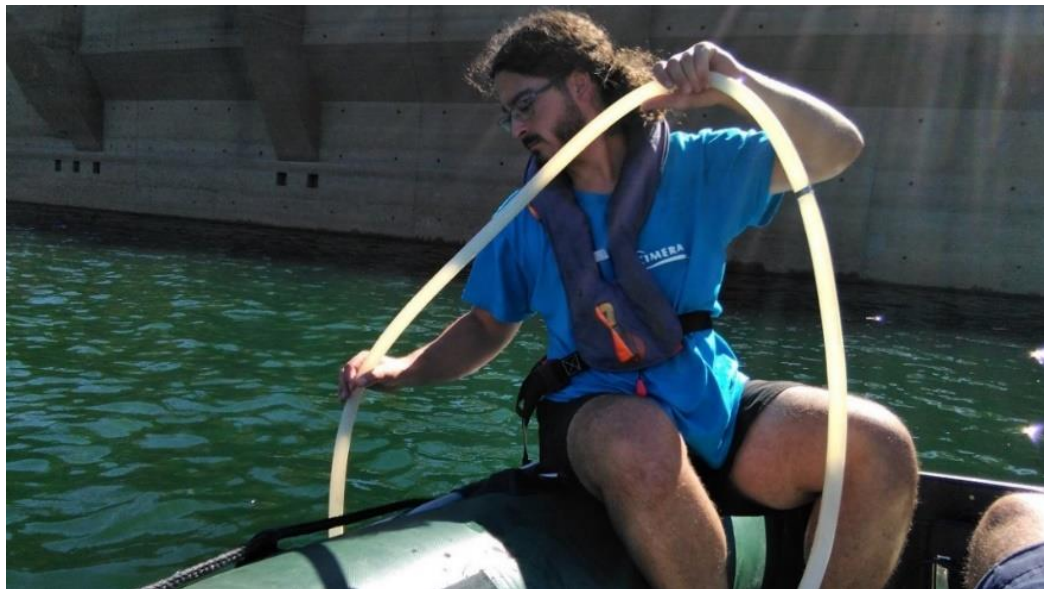
Figura 2 Toma de muestra integrada de agua mediante botella hidrográfica (arriba) o tubo de silicona (abajo)
