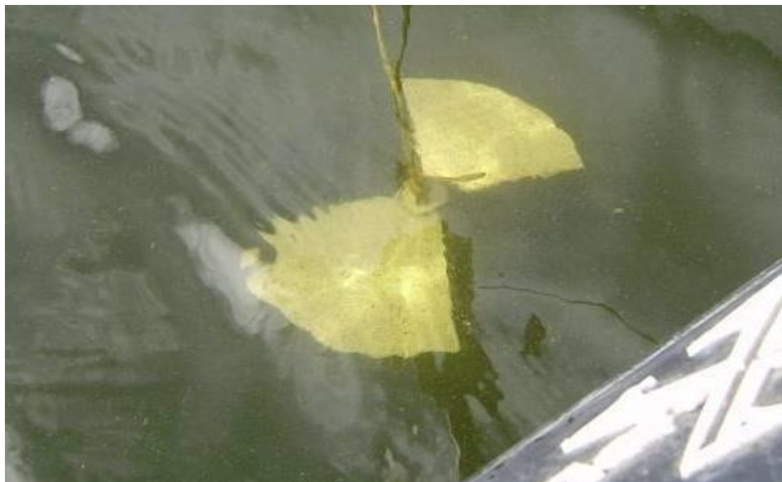
Figura 4 Uso del Disco de Secchi para medir la transparencia del agua y calcular la profundidad de la zona fótica
