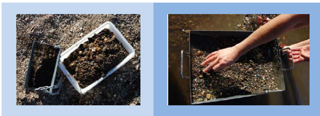
Ilustración 24. Imágenes de tamiz de muestreo de bivalvos (izquierda) y de draga con bandeja conteniendo el sustrato retenido en dicha draga. Fuente: Anhidra S. L. (2009).
