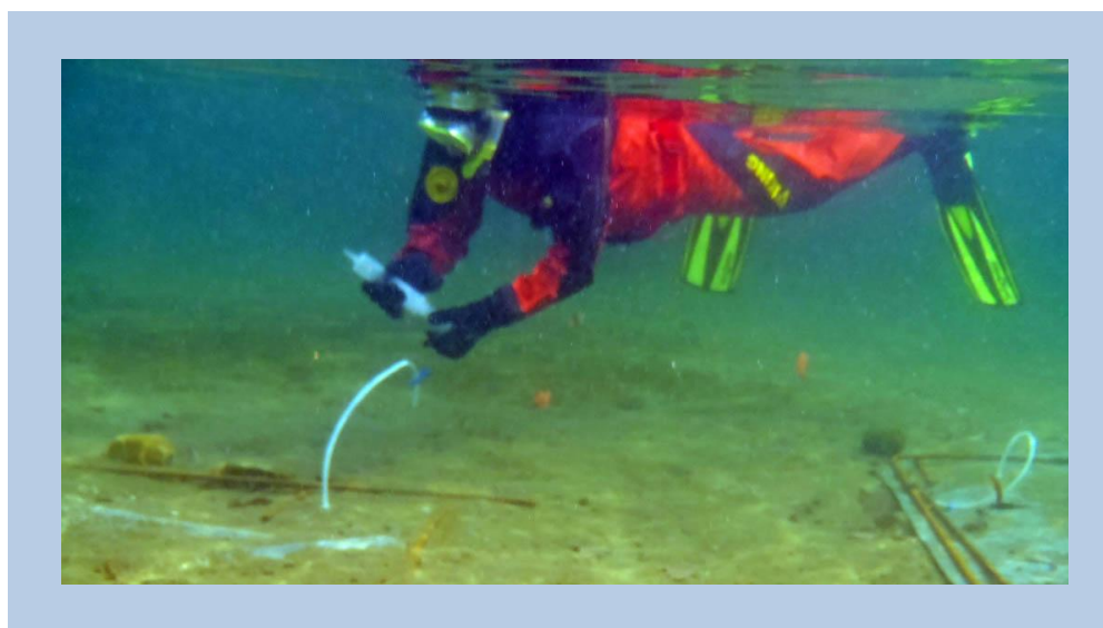
Ilustración 13. Operación de toma de muestra de agua bajo las mantas para análisis de oxígeno disuelto, amonio y calcio. Puede observarse que la toma de muestra se realiza con la ayuda de una jeringa que se inserta en un tubo fino por donde se extrae la muestra de fondo. Fuente: Lake George Asian Clam Eradication Project http://www.stoptheasianclam.info/ .
