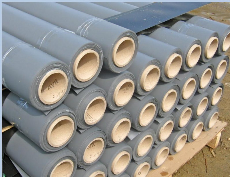
Ilustración 9. Mantas o barreras bentónicas preparadas para su instalación. Fuente: Lake George Asian Clam Eradication Project http://www.stoptheasianclam.info/ .
