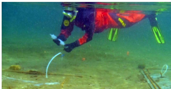
Ilustración 30. La toma de muestra se realiza con la ayuda de una jeringa que se inserta en un tubo fino por donde se extrae la muestra de fondo. Fuente: Lake George Asian Clam Eradication Project http://www.stoptheasianclam.info/ .
